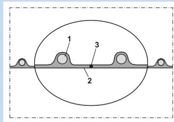
Antistatischer Polyurethanschlauch, leicht, mikrobefest, Erdungslitze
